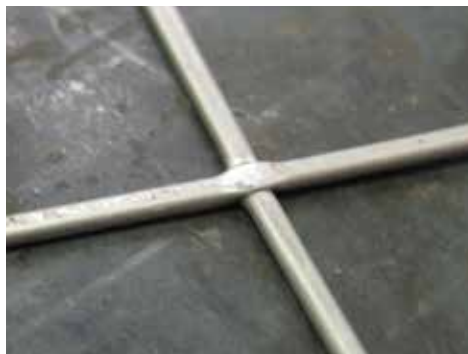
Рис. 7.2 Кабель нагревостойкий \varnothing 1,5 мм, после приложенного усилия в 28000 Н (2800 кгс)
