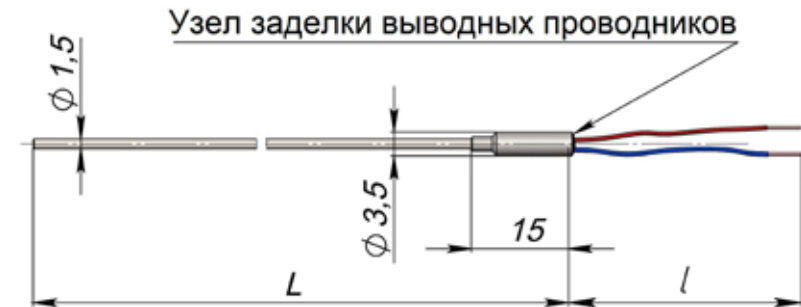
Рис. 1.4 Термопреобразователи КТК-01(ХА) и КТЛ-01(ХК) с заделкой выводных проводников в типовую стальную втулку
