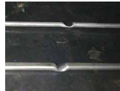
Рис. 7.2 Кабель нагревостойкий \varnothing 1,5 мм, после приложенного усилия в 28000 Н (2800 кгс)
