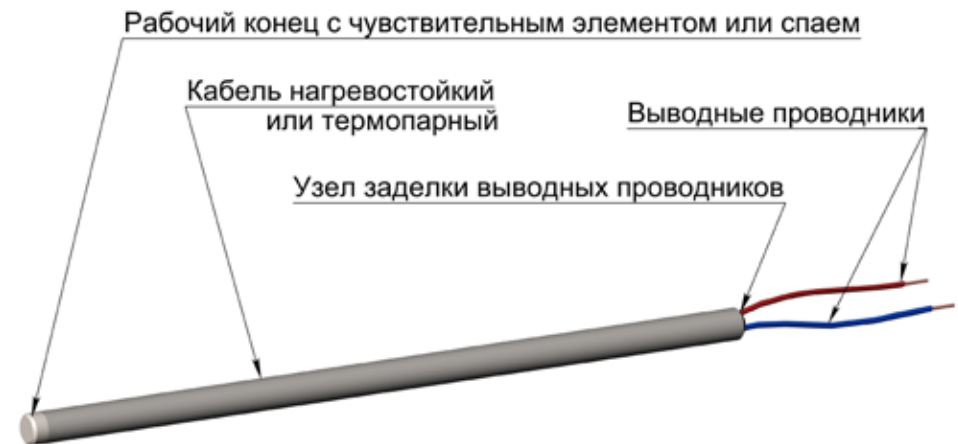
Рис. 1.1 Датчик температуры, наименование элементов
