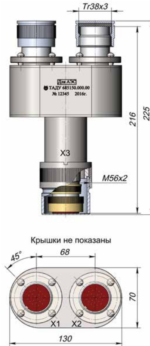
Рис. 5.3 Габаритные и присоединительные размеры исполнений ТАДУ 685150.000.00 и ТАДУ 685150.000.00-01.
